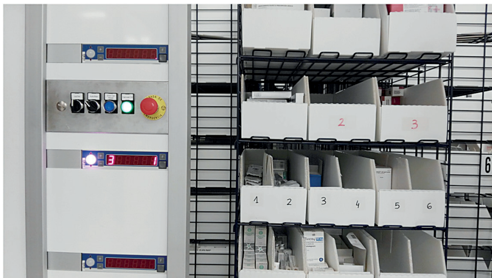
Imagen 2.4. Sistema de luces guía de los carruseles horizontales modelo HOCA P622/20.
